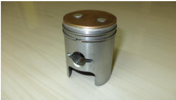
Fig: 1 Bi metallic piston
